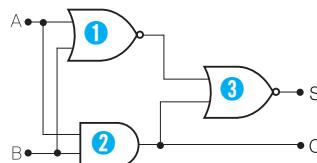
①은  $(A+B)$ 이고, ②는  $AB$ 이므로 ③은  $(\overline{1}+\overline{2})$ , 곧  $((\overline{A}+\overline{B})+AB)$ 이다. 간략화하면 다음과 같다.
