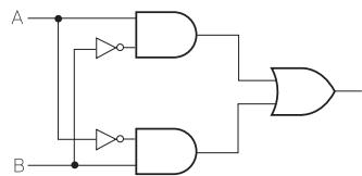
이것을 NAND 게이트만 이용하여 같은 기능을 수행하게 하려면, 부정의 부정이 원래의 값과 같은 값을 출력하는 원리를 이용하여 각각에 대해 NOT 게이트 두 개를 붙여 같은 결과를 출력하는 NAND 게이트로 변경한다.
